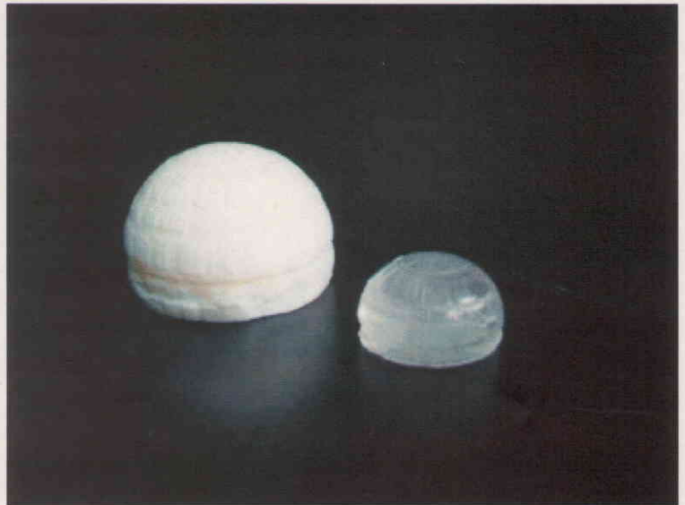
九州大学は石英ガラスの安価な成形法を開発。シリカ粒子を固めた成形品(左)と加熱後の石英ガラス。直径35ミリから20ミリに均等に収縮する(九大提供)
