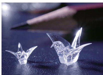
3D光造形技術を用いた微細形状を有する機能性ガラスの開発 (例 折鶴)
